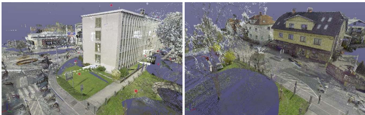
Slika 9: Zajem podatkov s pomočjo laserskega skeniranja - okolica stavbe (vir: GI, 2021).
