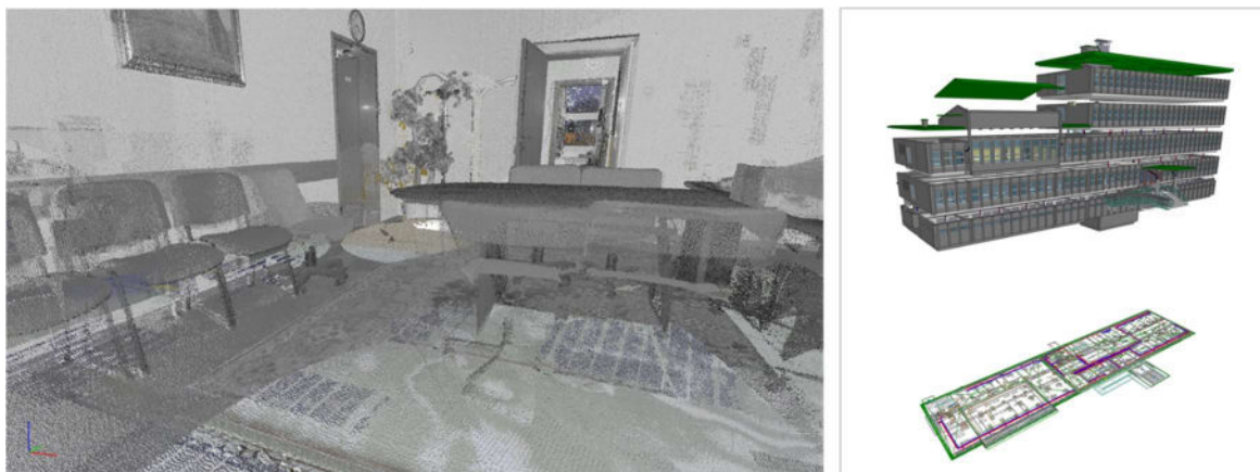
Slika 10: Lasersko skeniranje – BIM model notranjosti na osnovi izmerjenih podatkov (vir: GI, 2021).
