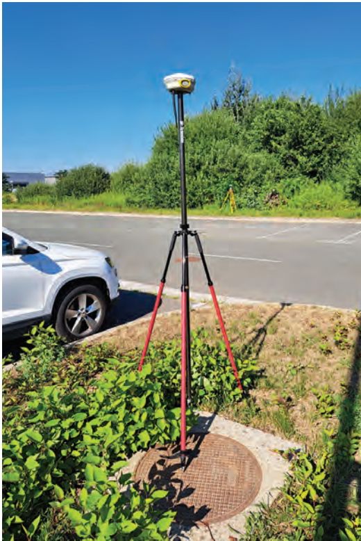
Terenske meritve z instrumentom GNSS
