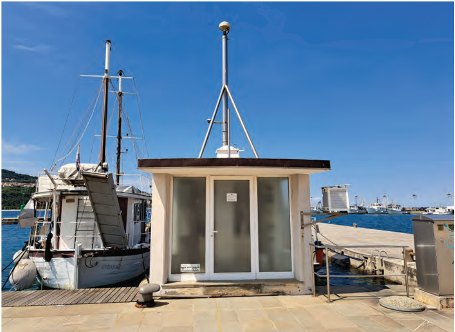
Antena stalne postaje GNSS na strehi mareografske postaje Koper
