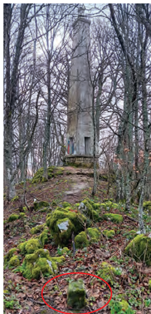
Tri zavarovalne točke trigonometrične točke I. reda na Trdinovem vrhu
