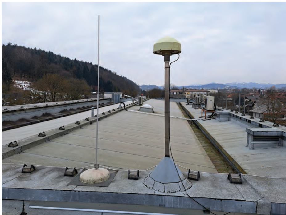
Antena stalne postaje GNSS v Ljubljani
