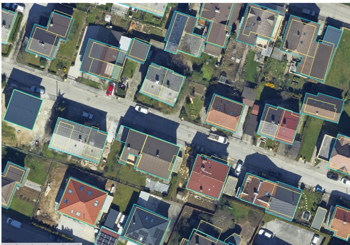
Slika 9: Obrisi streh, ki so bili avtomatsko narejeni iz POF v projektu PAF-test (modri poligoni); sloja KN_SLO_STAVBE_TLORIS_poligon in STAVBE_NADZEMNI_TLORIS (rumeni poligoni).
