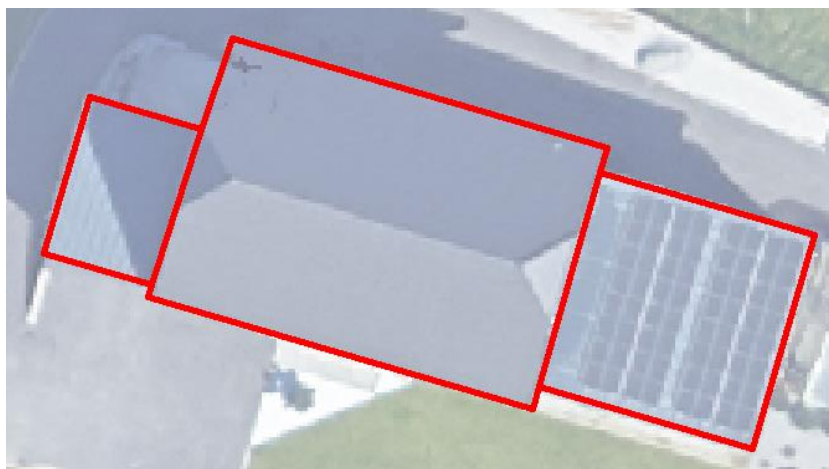
Slika 33: Avtomatizirano izrednoteni 2,5D poligoni tlorisa stavbe v tem testu.
