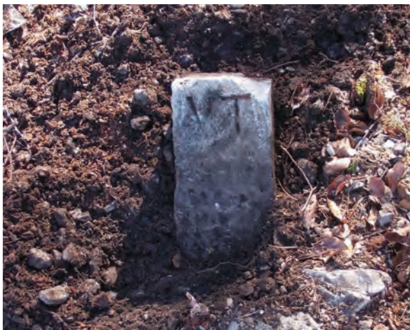
Loza (876 m): oznaka trigonometrične točke III. reda št. 160 v trigonometričnem okraju Postojna
