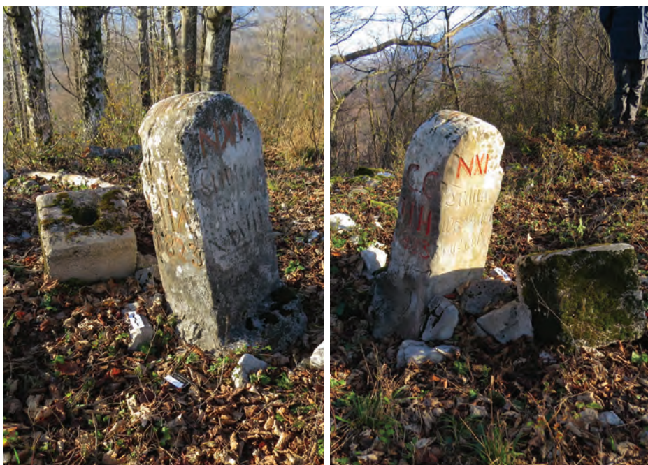
Klesani mejnik in poleg njega ostanek italijanskega trigonometričnega stebra na Travnem vrhu z dveh strani
