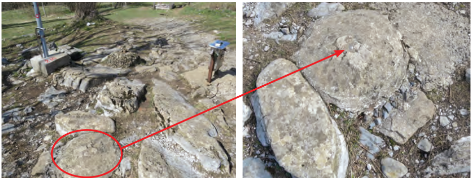
Glavna točka trigonometrične točke Z0 II. reda št. 301 je označena z manjšim kovinskim čepom
