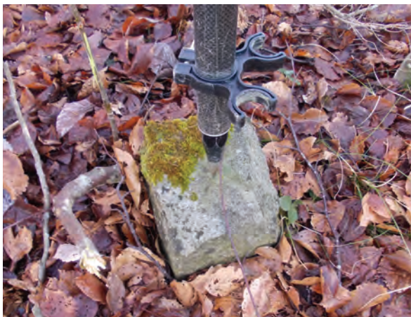
Medvednica (1024 m): oznaka trigonometrične točke IV. reda št. 532 v trigonometričnem okraju Postojna
